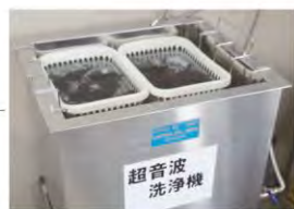
4 取り切れない汚れは 大型超音波機で再度洗浄
